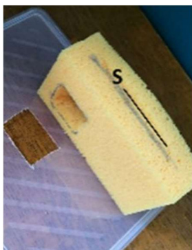
Слика 4.3.а. Припрема пластичне кутије и сунђера за постављање мобилног телефона На једној страни сунђера (А) налази се отвор који је идентичан отвору на поклопцу кутије, тј. месту где се налази камера мобилног телефона (Слика 4.3.б).
